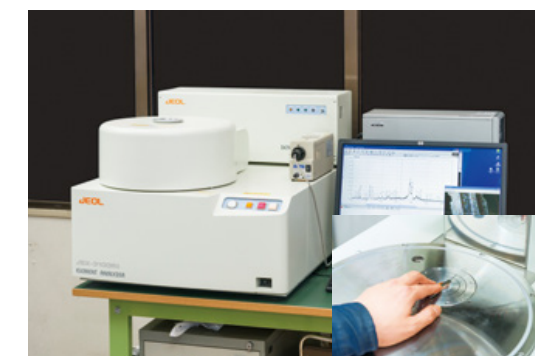
化学物質測定 (蛍光X線分析装置) 日本電子株式会社様 JSX-3100R型
