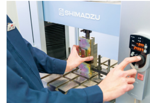
荷重試験 (精密万能試験機) 株式会社島津製作所様 AGX-20KNG
