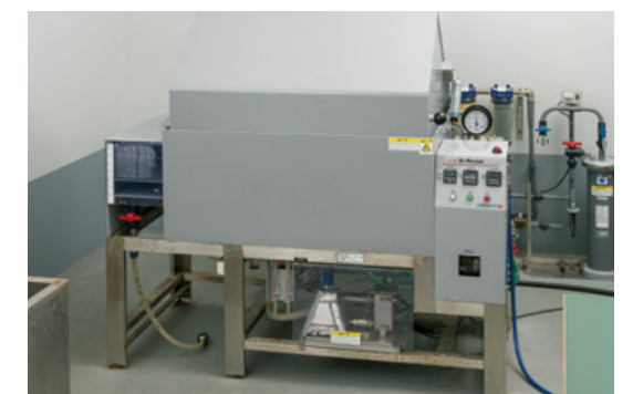
耐食性試験 (塩水噴霧試験機) スガ試験機株式会社様 STP-90
