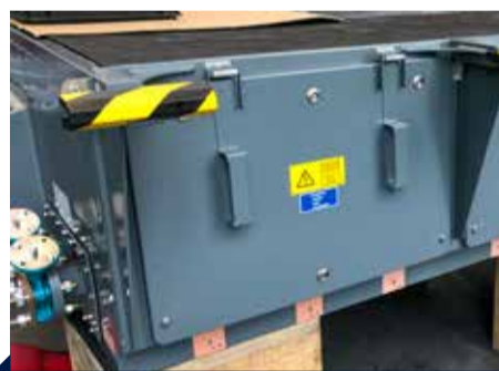
Für die Leistungselektronik und Antriebstechnik in Zügen und Bahnen sind Traktionsstromrichter und Hilfsbetriebeumrichter zuständig. Traction converters and auxiliary converters are responsible for the power electronics and drive technology in trains and trams.
