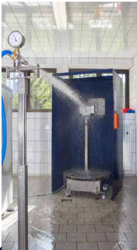
Die Strahlwasserprüfung nach IPX5 und IPX6 ist eines der Testverfahren im neuen Prüfzentrum. The jet water test procedure, compliant with IPX5 and IPX6, is one of the test methods in the new Test Centre.
