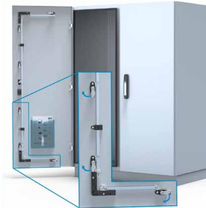
Schaltschrank mit elektronischem Schwenkgriff, Mehrpunktverriegelung mit Eckumlenkung, 3-fach-Scharnierung und PE-verschweißten Dichtungsrahmen. Control cabinet with electronic swinghandle, multi-point locking system with corner deflection, 3-fold hinges and PE-welded sealing frame.
