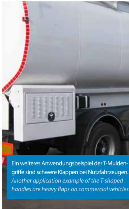
Ein weiteres Anwendungsbeispiel der T-Muldengriffe sind schwere Klappen bei Nutzfahrzeugen. Another application example of the T-shaped handles are heavy flaps on commercial vehicles.
