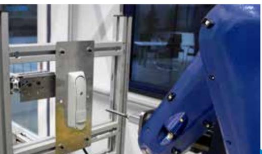
Robotergestützte Dauerlaufprüfung eines elektrischen Schwenkgriffes im EMKA-Prüflabor.
