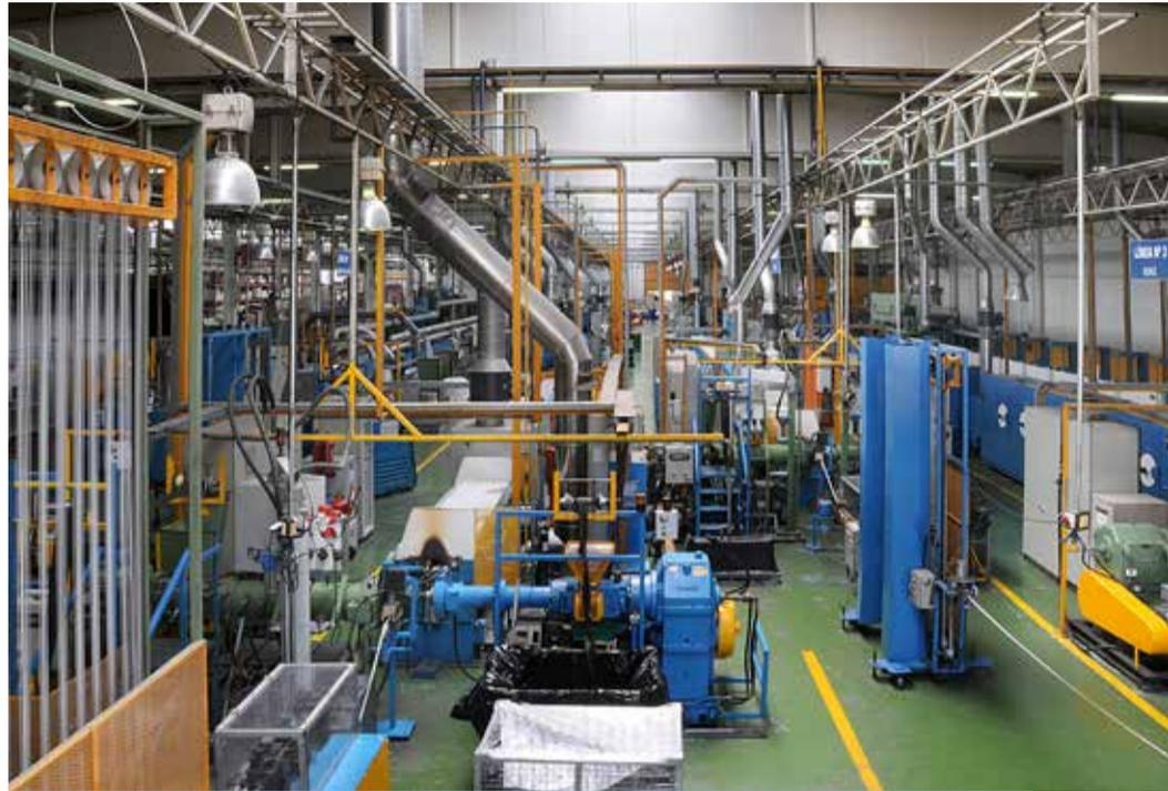
Produktionshalle mit 4 Gummi-Extrusionslinien mit UHF- und Salzbad-Vulkanisation.
