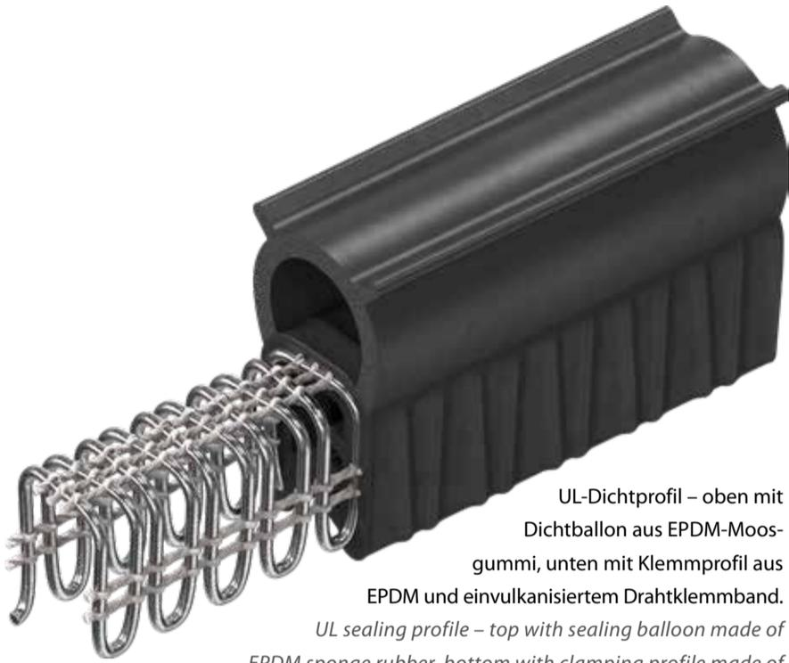
UL-Dichtprofil – oben mit Dichtballon aus EPDM-Moosgummi, unten mit Klemmprofil aus EPDM und einvulkanisiertem Drahtklemmband.
