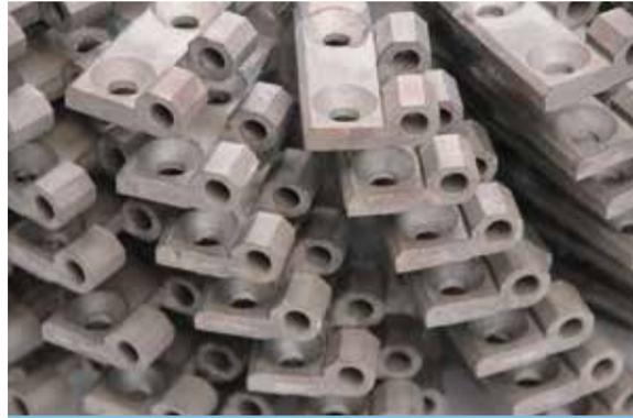
Punktsymmetrische Scharnierhälften, die zum Ende der Fertigung ein Scharnierpaar bilden werden.
