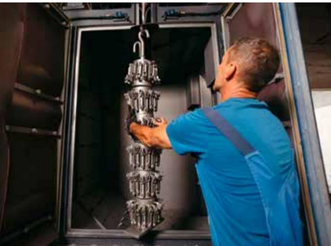
Mittels einer Sandstrahl-anlage wird die keramische Hülle von den Gießtrauben entfernt.
